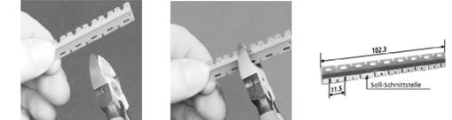
Die benötigte Anzahl an Kontakten mit einem Seitenschneider an der entsprechenden Sollschnittstelle abschneiden. Dann die Durchschaltbrücke von oben in den Kontaktschlitz einsetzen und herunterdrücken.
