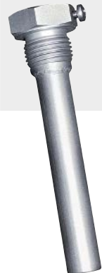
THR -VA-17 / xx Погружная гильза из высококачественной стали V4A (1.4571) с плоским уплотнением, цилиндрическая, согласно DIN 228
