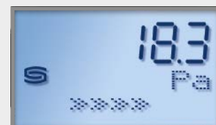
стандартное исполнение Фактическое давление (в Па) Интервал коррекции (стрелки)
