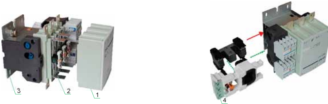
1: Дугогасительная система 2: Контактная система 3: Основание 4: Магнитная система
