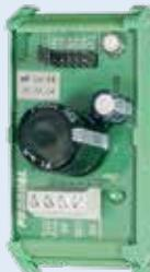
Импульсный источник питания JY — многофункциональный преобразователь постоянного и переменного тока в переменный ток. Это один источник постоянного тока, который вам нужен. Полезен как источник питания для токовых контуров. [Стр. 98](#)
