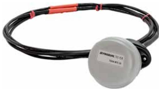
Датчики TEKA – предназначены для измерения средней температуры внутри воздуховодов большого сечения. Гибкая конструкция измерительной части датчика содержит 4 чувствительных элемента. Длина конструкции может составлять или 3 м, или 6 м по запросу.
