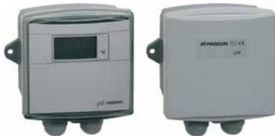
Преобразователи LLK V2 и LUK V2 предназначены для измерения температуры. LLK V2 – 2-проводной преобразователь, преобразующий выходное сопротивление датчика в сигнал 4...20 мА. LUK V2 – 3-проводной преобразователь, преобразующий выходное сопротивление датчика в сигнал 0...10 В.
