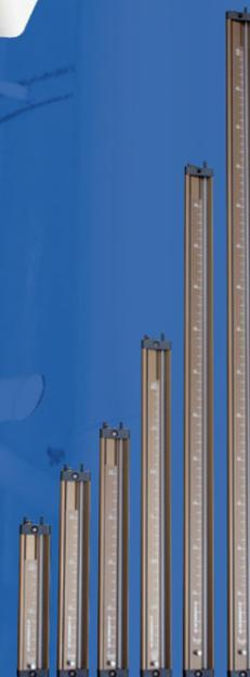
Жидкостные манометры — надежные и недорогие традиционные приборы для измерения давления. Эти манометры используются для измерения и определения небольшого избыточного давления, вакуума и перепада давления воздуха и неагрессивных газов в диапазонах низкого давления.
